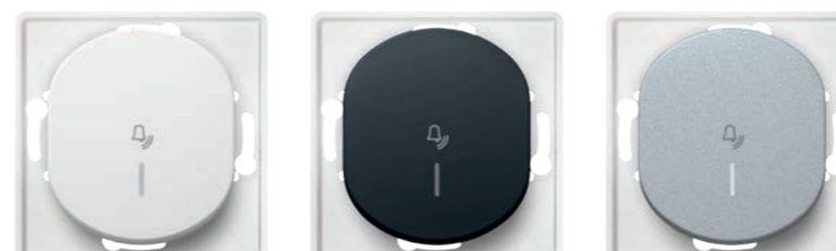
E6101.x Taster sklopka za zvono sa indikacijom 10AX/250V~ Bell push-button switch with indication 10AX/250V~ • Indikacija svetli kada je sklopka isključena • Indication turns on when the switch is off
